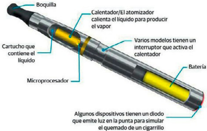
Figura 1. Partes de un cigarrillo electrónico
